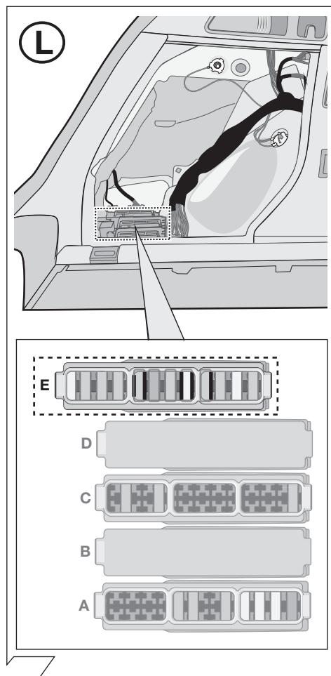
Sicherungskasten B rot / Fusebox B red
